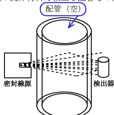
線源から発したガンマ線は配管と密度測定流体を透過した後、検出器に入り検出される。流体を透過する課程でガンマ線の一部は散乱を受け、検出器には到達しません。この散乱を受ける割合は、流体の密度に依存しています。この関係は次の(1)式のようになります。
