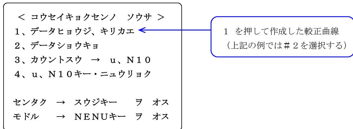
ここで較正曲線を作っても運用する曲線番号が変わらないのは、通常運転中に計算式等の作成作業を行っても 4/20 mA データが変化しないための処置です。
