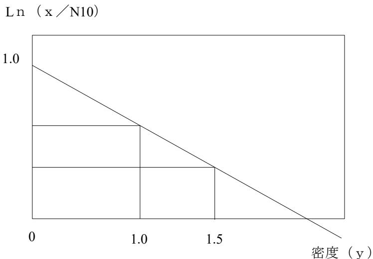
ガンマ線強度が分かれれば、未知の密度値はそのときのガンマ線強度を測定すれば判ります。また、間接測定法であるために何らかの較正作業により装置定数を決める必要がありますが、それには密度値があらかじめ既知の資料2種類があれば較正可能となります。
