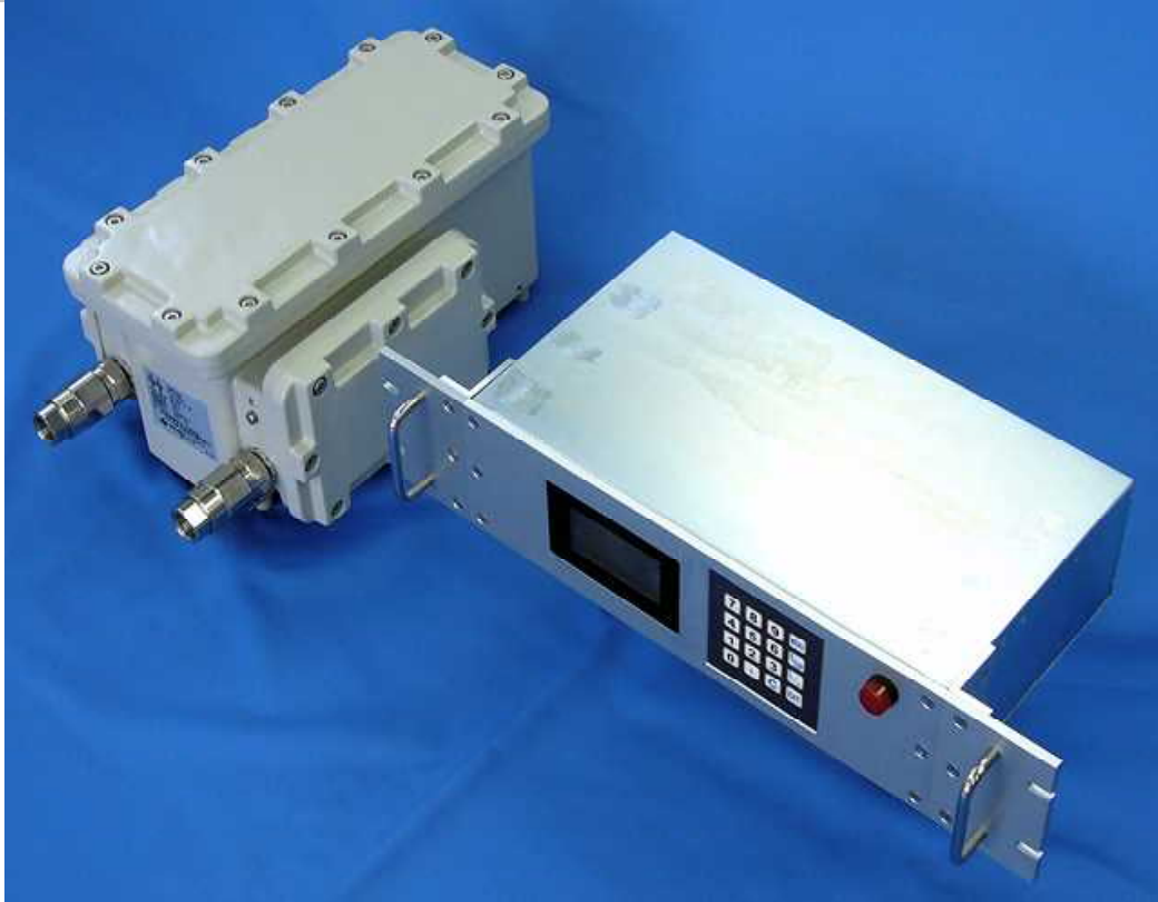
GDB-7000 検出部および操作部 (左が配管に付ける検出部、右が操作部)
