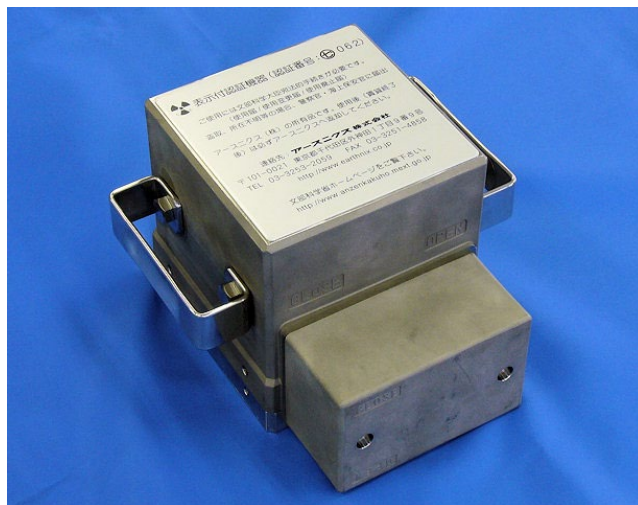
箱型シャッター付線源ケース (A型線源) (表示付認証機器 承認番号 ㊦062号)
