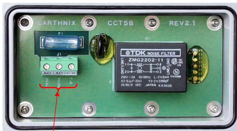
検出部側および操作部側 電源ケーブル端子台 (共通)
